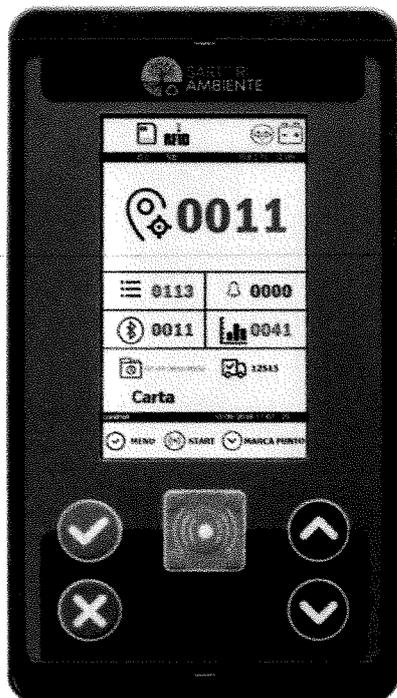
Dispositivo per la lettura, la georeferenziazione, la memorizzazione e l'invio dei dati (svuotamenti e percorsi) relativi al servizio di raccolta dei rifiuti. Permette la lettura di codici in tecnologia UHF EPC Gen 2 installati su mastelli, sacchi e contenitori carrellati.
